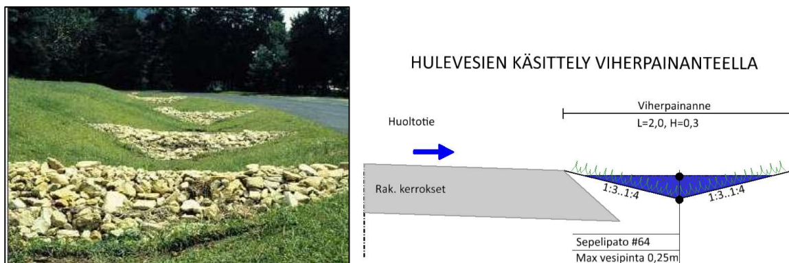
Kuva 6 Esimerkki ojatkosta (Virginia Stormwater Management Program) ja tyypileikkaus huoltoteiden yhteyteen rakennettavista viherpainanteista
